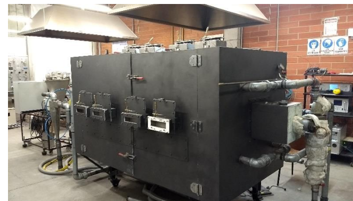
Horno de combustión sin llama, para mezclas gas-liquido, sólido-gas.
